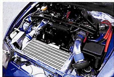
←↑3S-Gターボは低く後方にマウン トされている。そしてインタークーラー は前方斜めにセットされ、走行風はバン パー開口部からボンネットエアダク トへ抜けていくのだ
