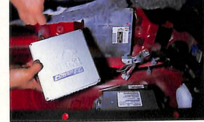
シーケンシャルシフト仕様は、ECUの近くにトランスミッションコントロールコンピューター(写真下側)を装着して、お互いにリンクして制御している(らしい)。ややこしうなので、今のところパワーFCをサブコンのように接続して、燃調と点火時期だけをセッティングする方法を検討中。
