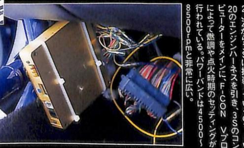
2JZから3S-GTEに換装して、2000rpmから2000rpmのエンジンハーネスを引き、SSSのVプロによって燃調や点火時期のセッティングが行われている。パワバンドは4500rpmと非常に広い。
