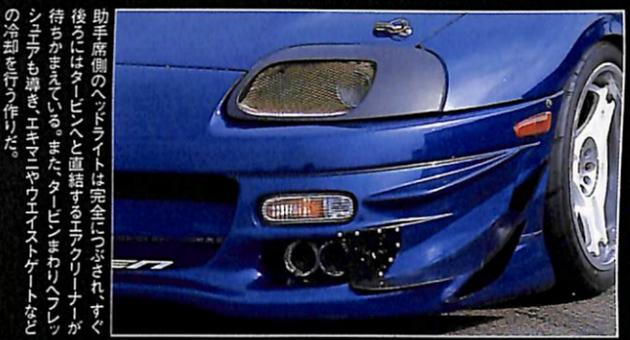
トライアルエアロをベースに、カナードやブレーキダクトの増設など、空力と冷却を考えたエクステリア作り。リアアンダーのディフューザーも非常にきれいな作りだ。フロントはフェンダーを外にズラす加工、リヤはフェンダーのたたき出し加工がほどこされている。ボディの重量バランスは50:50に限りなく近い数値に収められているようだ。
