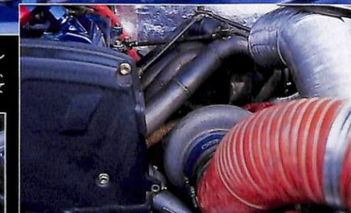
ボア87φ×ストローク91mmの2162ccに排気量アップされ、カムはHK Sの272度を使う。組み合わせられるのは、低回転からの立ち上がり定評のあるGT3240タービン。最大ブースト1.6kg/cm時に約600psものパワーを発生する。エキマニには数々の補強ステーが入れられ、重たいタービンをしっかりとさえる。
