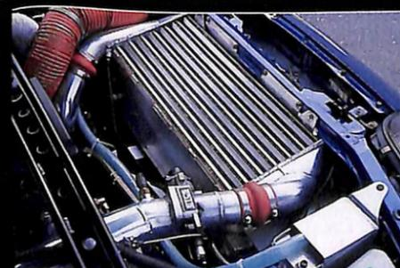
高回転の伸びと、気筒ごとに均等な燃焼を得るため、サージタンクはワンオフされている。スロットルは2JZのものを使用。また、850ccのメインインジェクターを使い、F-CON Vプロで制御している。
