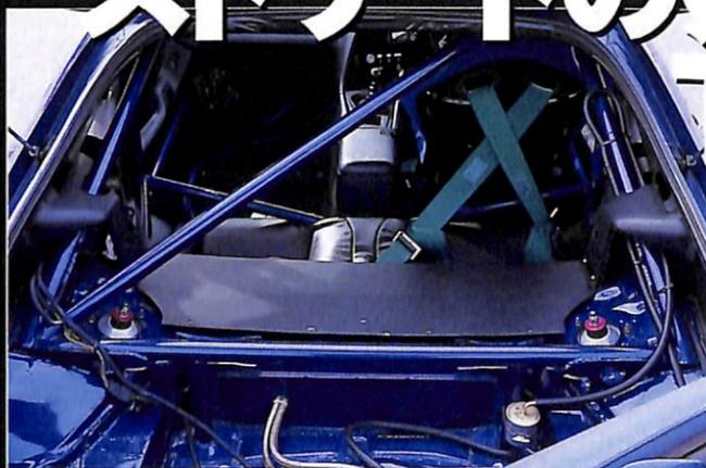
センターパネルのスイッチ類やダッシュボードの3連メーター類がある以外は、カーペットも敷いてあるストリートカーへの作り。でも、助手席の代わりにバッテリーが移動されていたり、ロールバーが溶接留めされているあたりは、サーキットを意識した本格派の作りといえるだろう。また、さり気なくタコメーターも視認性のいいタイプに交換されている。
