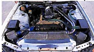
Y33用VQ30エンジンをスワップし、オリジナルN1 SPLタービンをついでに装着。タービン容量的には600ps以上をねらえるのだけど、ネックになるのはピストンとブロー。もちろん強化の鍛造ピストンなどないため、この馬力を常用するとなれば作るしかない。
