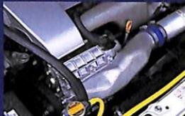
2ZZの場合、エアコンコンプレッサー、パワステポンプなどを動作させているのは1本ベルト。スーパーチャージャーが加わるためキットには専用ベルトが付属されている
