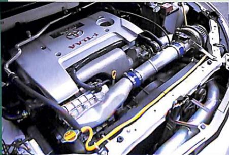
NAを手っ取り早くパワーアップさせるならボルトオンターボがある。しかし2ZZはEXマニがバルクヘッド側にある後方排気のためスペース的にツライんだよね。スーパーチャージャーならオルタネーターの位置を移動させることで簡単にセットできるのだ。エンジン本体はまったくのノーマルながら242psを発揮している。
