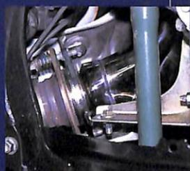
ワンオフのステンレスマフラーはメイン70φの100φダブル出し。ウィルVSの純正マフラーは左側のシングル出しだが、センターにラインが入った左右対称のスタイリングを考慮してあえてダブル出しにしているのだ
