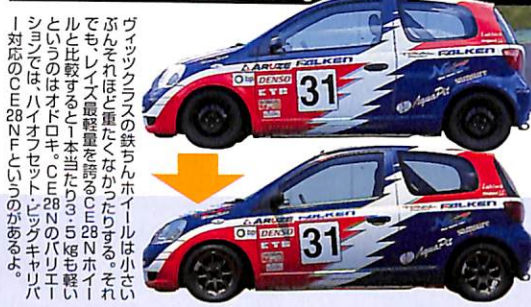
サンプル車両 トリアルヴィッツFK 純正vsTE37パネ下重量差: 14kg
