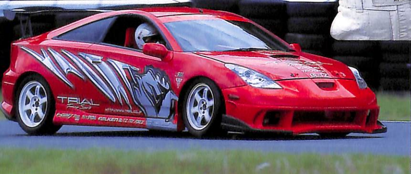
トリアフォースエアロのバージョンIIを装着(7万5600円)。リップ部分のカーボンのカバーはいまのところ価格未定。排気量が2.0になる3ZZチューンエンジンに、ブリッツのコンプレッサーを装着し280psをたたき出すトリアルセリカ。ガルウイングも自慢だ。
