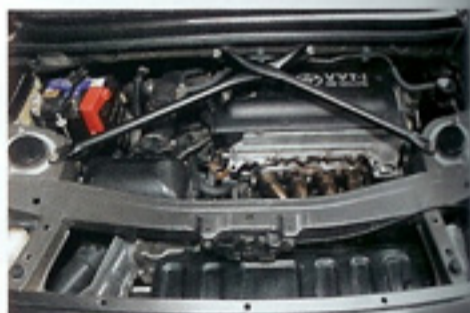
MR-Sには、排気量1794cc、ボア×ストロークはφ79×91.5mmというロングストローク型で、最高出力140ps/6400rpm、最大トルク17.4kgm/4400rpmの1ZZ-FEのみが搭載された。このデモカーはあえてノーマルエンジンのまま、吸排気チューンのみでパワーアップを敢行している。
