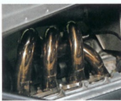
MR-Sには、排気量1794cc、ボア×ストロークはφ79×91.5mmというロングストローク型で、最高出力140ps/6400rpm、最大トルク17.4kgm/4400rpmの1ZZ-FEのみが搭載された。このデモカーはあえてノーマルエンジンのまま、吸排気チューンのみでパワーアップを敢行している。
