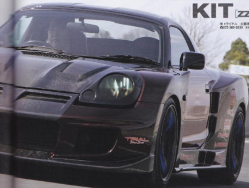
①構造に対して100m延長することで、なぜか走行プラスするフロントドライバースペイサー。一種類形される大型リップスペイサーがフロントのダクランフォースを高めてくれる。また、フロントマスクを引き締めるヘッドライトカバーも装備。
