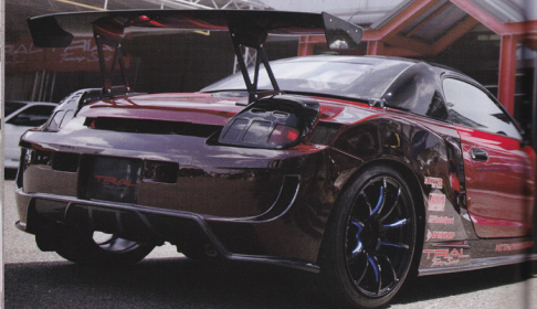
トライアル牧原さん 「このワイドボディは片側55mmオーバーとなる全幅1800mm。コンパクトなMR-Sはパワーを大幅に上げていくとミッドシップ特有のピークを特性が顕を出してくるけど、ワイド化することによってグンと乗りやすくなるということ。MR-Sにとってのワイドボディ化は、それこそもったい足まわりなどの作り込みをキッチリ合わせこんでやれば信頼性のよさを残しつつ、それを絶対的なコーナリング性能のアップにつなげるこ
