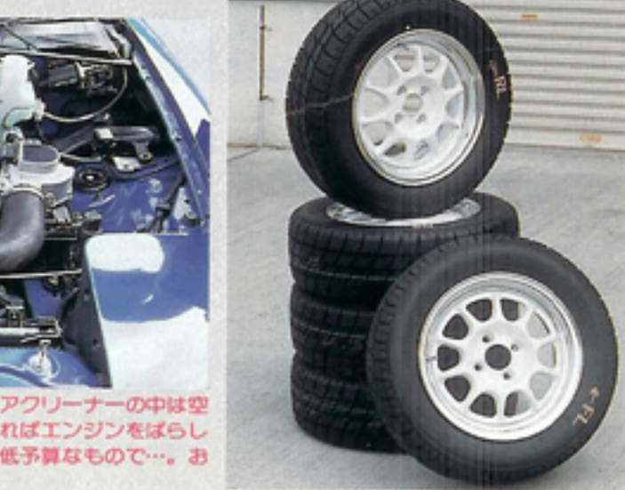
タイヤは横浜ゴム製のADVAN021Rを採用。サイズはフロント、リヤ共に185/60-14。グリップレベルが高い上、サイドウォールの剛性が高いのでOPTが狙った、コーナリングをばらばらせず、高いスピードを維持する。にはびつたりのタイヤだ。レース時はハードコンパウンドを維持する。にはびつたりのタイヤだ。が、タレも少なく、後半30分の間に足元を救われることもなかった。ホイールはエンケイのRCS。軽量化でハネ下重量の軽減に効果アリ。レーシングフィールドでも大好評だ。
