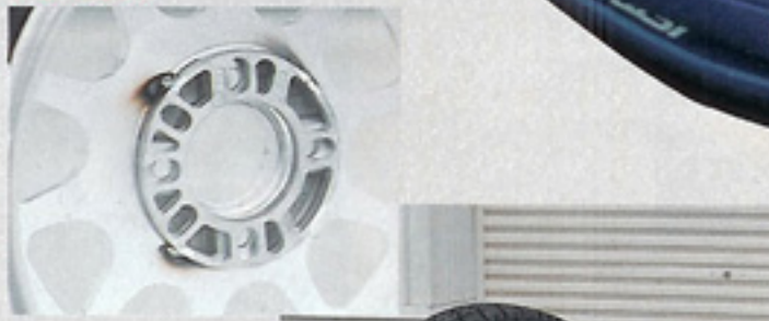
もともと特注オフセットのエンケイのホイールに、さらにスペーサーをスポット溶接して、オフセット値を変更。フロント25、リヤ19とし、トレッド幅を調整。フロント、リヤで12mmの差となり、曲がりやすく、クリッピングでの踏んばりもひと味違う。
