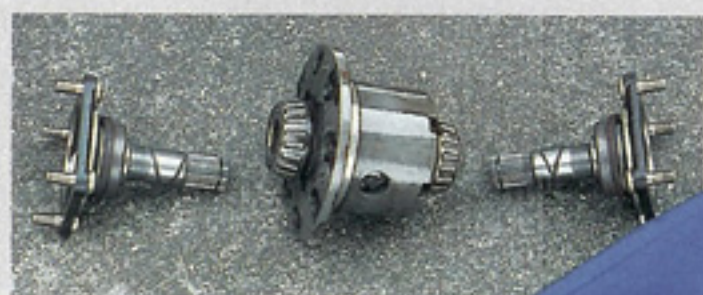
デフはクスコの機械式LSDをチョイス。インシャルトルクは12だが、今回は1段あげて効きを強めた。アンダーが出やすくなるが、そこはきっちり固めた足まわりで受けとめ、高いコーナリングスピードを維持。コイツは欠かせないパーツだぜ。
