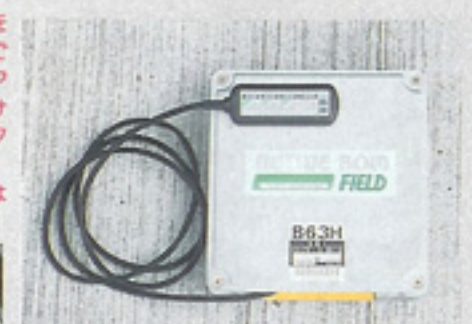
コンピューターはフィールド技研の協力のもとにデータを全面的に見直した。シエイクダウン時はアクティブフロムで4種類のデータを比較、もっともタイムが出て、燃費の良いセッティングを探ってみた。マツダスピード製はA/F値が11と濃いめだが、OPTチームは高負荷時でA/F12.5と、薄めにしてパワー&燃費をかせいだ。
