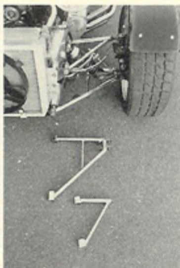
手前がノーマルのフロントアームで、装着しているのが今回テストしたロングアームだ。写真ではわかりにくい、この効果は絶大。コーナリング中のクルマの姿勢が安定し、極端なリバーステアも打ち消された。操舵感のヌケもきれいになくなり一石三鳥って感じだね、こりゃ。
