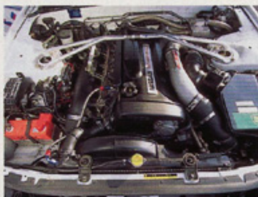
ノーマル然としたエンジンルーム。今回は新開発のスーパーアウトレット+フロントパイプも装備。コイツがよく効く。
