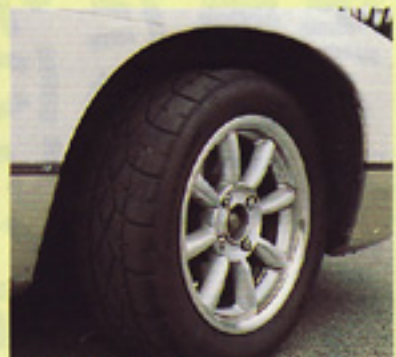
タイヤは当然セミレーシング。BS520 Sの(F)205/50-15(R)205/60-15を履く。フロントが異様に小さいのは50だからだよ。
