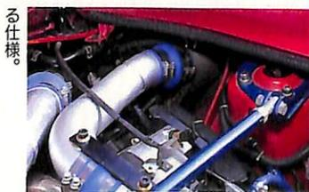
MR2の狭いエンジンルームでは、いろいろなパーツを詰め込むのは難しい。オリジナル4層インタークーラーさえこのエンジンルームの中に入っているのだからタイヘンだ。タービンはT04RでウェイトゲートはHKSのレーシング。インジェクターはメインを850ccに交換。コントロールはメインコンピューターで行う。燃料ポンプはR33GT-R純正とボッシュを使う。
