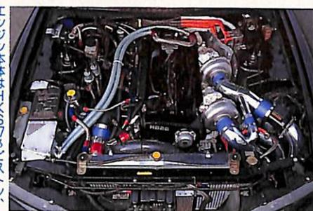
W76をチョイス。推定900psのマックスパワーをかきながら、ヘッド加工、アベックス280度カム(1N/EXとも)、どうまくセッティングをとり、中速域のレスポンスを損なわず、9500rpmまで一気に吹け上がる内容に仕上げている。軽量化なしで10秒前半は立派だ。
