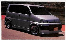
各2種類ある前後のハーフスポイラー、サイドステップ、オー バーフェンダーのほか、デュアルのセミステンレスマフラーや 車高調整式サス、リアブレーキをディスク風に見せる楽しい「ナ ンチャッテディスク」もある。
