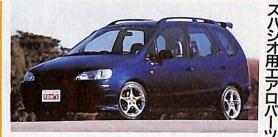
空力特性向上と腰高感減少を両立させるためにデザイン。 フロントスポイラー(マルチリフレクターフォグンプ装着 車は不可)やフロントグリル、サイドステップ、リアアン ダースポイラー、リアウイングが揃っている。
