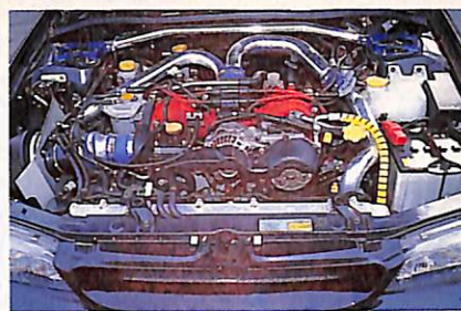
現在のカツオ号のエンジン関係チューニングは、ブーストアップ、等長エキマニ(クランク)、前置きインタークーラー(クランク)、大会用ラジエター(ARC)、マフラー(クランク)こいで3000psオーバーを実現!
