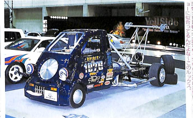
エンジンから駆動系はシンプルな通り。リヤタイヤは12J×17と極太。
