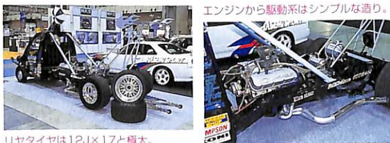
エンジンから駆動系はシンプルな通り。リヤタイヤは12J×17と極太。
