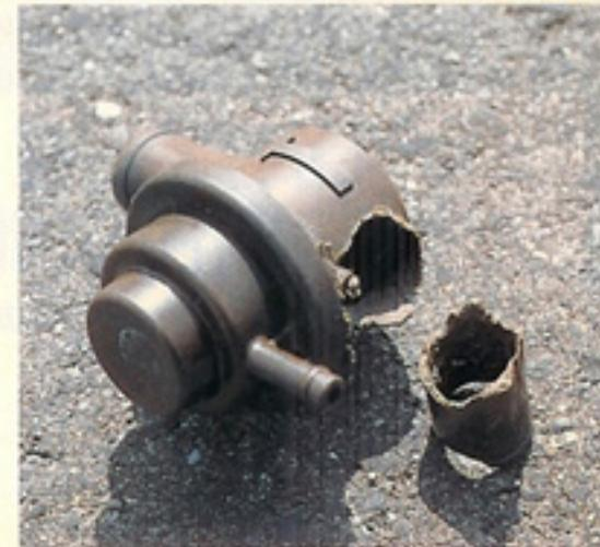
FD3Sのブローオフバルブはプラスチック系。HKS関西サービスのFD3Sは写真のように破損してしまった
