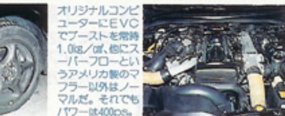
オリジナルコンピューターにEVCでブーストを常時1.0kg/分、他にスーパーフローというアメリカ製のマフラー以外はノーマルだ。それでもパワーは400ps。
