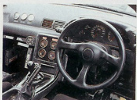
◀センターコンソールとダッシュボードに8つの追加メーターが並ぶ。助手席ヒザ元にはトリアルオリジナルのCPとFコンをセット
