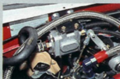
4連スロットルの負圧はここで一つにまとめられ、VPCのセンサーへとつながる。
