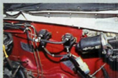
VPCの負圧センサーはバルクヘッド右側に固定。感知したデータをVPCに送る。
