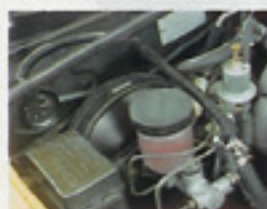
右がフューエルレギュレーター。バルクヘッドには燃圧計が。
