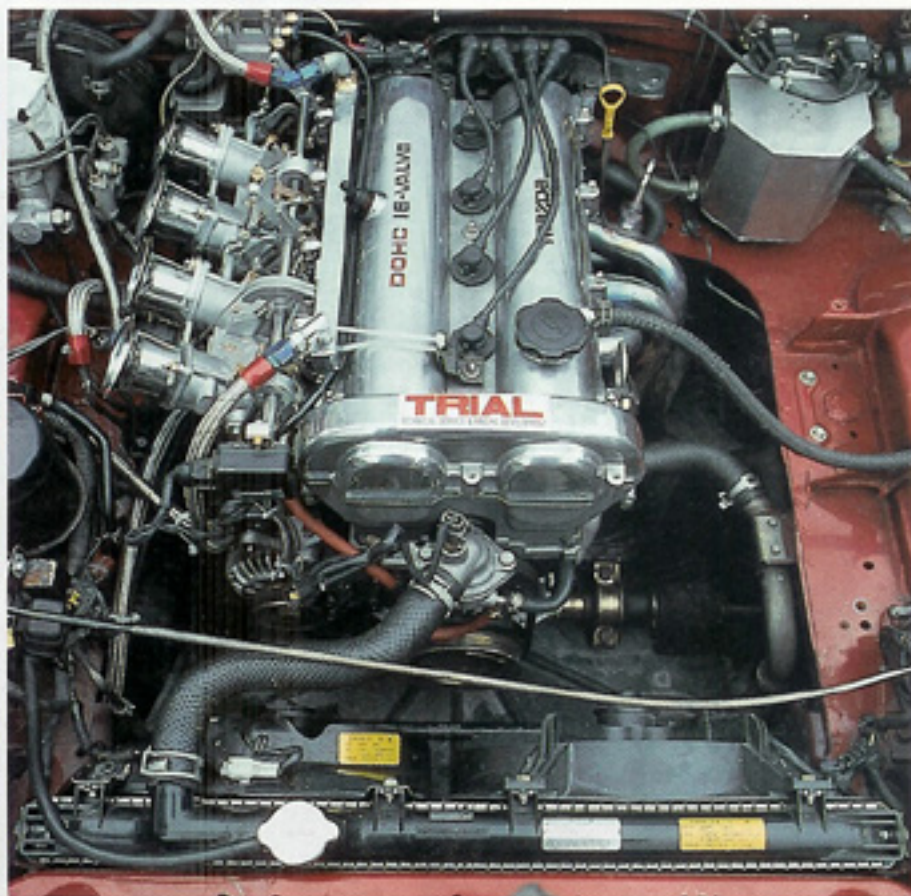
4連スロットルキットは、下迫力度では文句なしのNo.1。高速域のパワーはもちろん、リセッティングによって下からの扱いやすさも同時に実現している。
