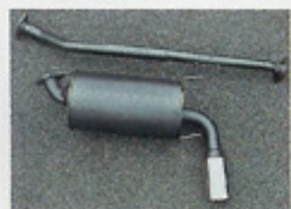
トライアル独自のメガホン形状マフラー。パイプ径は3段階で大きくなり、出口は精円長で90φになる。
