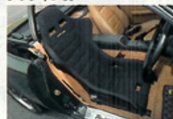
シートはマツダスピード製フルバケット。ロールバーはオリジナルの「ルーファ」。斜めのステーを外している。
