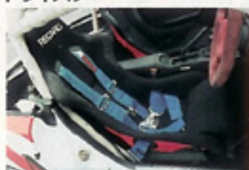
シートはレカロSP-Gで4点式ハーネスはパイロテクト。ロールバーはマツダスピードの6点式が付いている。
