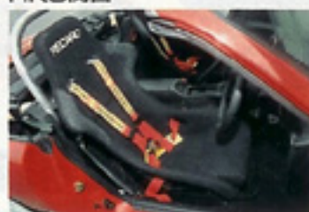
シートは同じレカロSP-Gで4点式ハーネスはサベルト。ロールバーはオリジナルのアルミパイプ仕上げ4点式。
