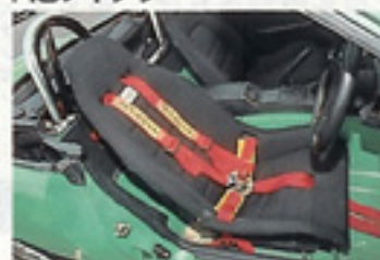
シートはプロショップニックイ製で5点式ハーネスはサベルト。ロールバーはT-HOUSEのキャメルバーだ。
