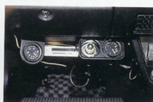
左より水温計。リターダー、ブースト・コントローラー、ブースト計が助手席に置かれる。
