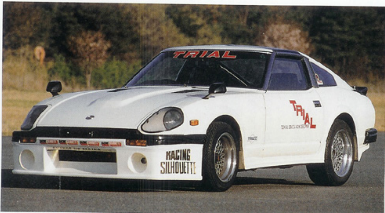
徹底的にエアロ・チューンされたボディ。フロントはチェンジアップレーシングVG30用スポイラーを使用。サイドとリアアンダーはシグマ製。リアスポイラーはワタナベ製だ。ボディのダウンフォースは実にバランスが良い。
