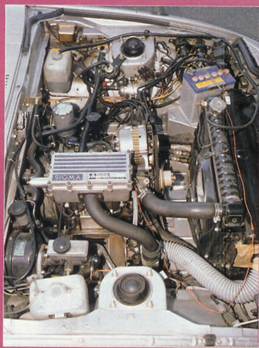
KKKターボ装着の12A型RE。電気関係はコーエイのCDI、連続放電タイプを装着。
