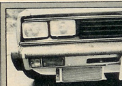
●森 健スカイラインGTターボ ラップタイム1分18秒72 区間最高速80.92 km/h ヘッドライトの改造とオイルクーラーが装着されている
