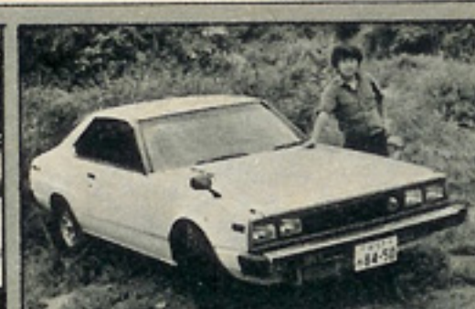
●森 健スカイラインGTターボ ラップタイム1分18秒72 区間最高速80.92 km/h ヘッドライトの改造とオイルクーラーが装着されている
