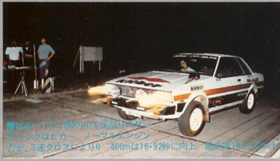
■数多いT字形跡の中でも足回りのセッティングはピカ一。ノーマルエンジンたが、3速クロスにより0~400mは16.92秒に向上。最高速163.64km/h
