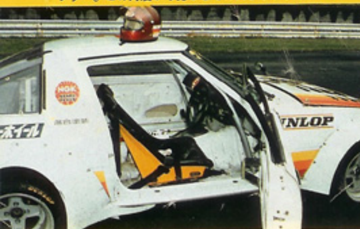
21 グループ5、RX-7のcockpit。深いバケットシートに注目
