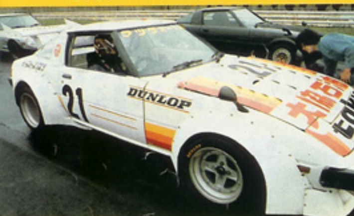
太いレーシングタイヤをクリアするためのオーバーフェンダー。この角度から見るとその大きさがよくわかる
