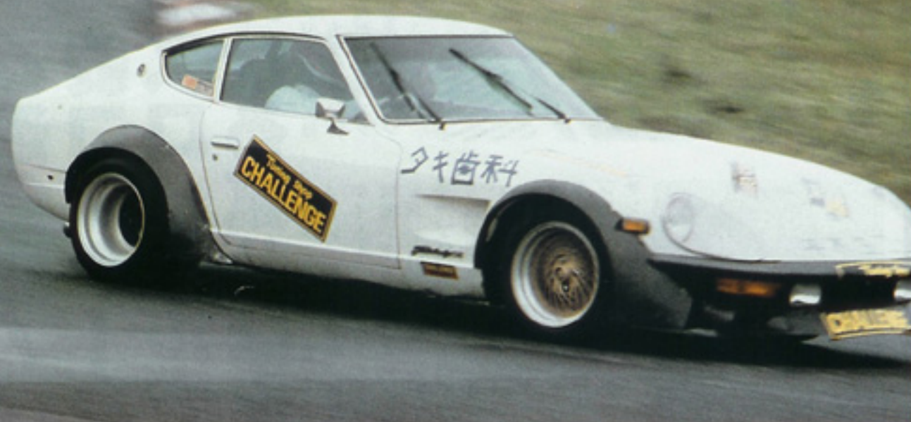
大きく張り出した日産純正レース用のワークスオーバーフェンダー。そして、大型のチンスポイラー、カン高いエグゾーストノートを発するメガホンマフラーなどが印象的だった3.1ℓのZ。サイドにエアのアウトレットもついている
