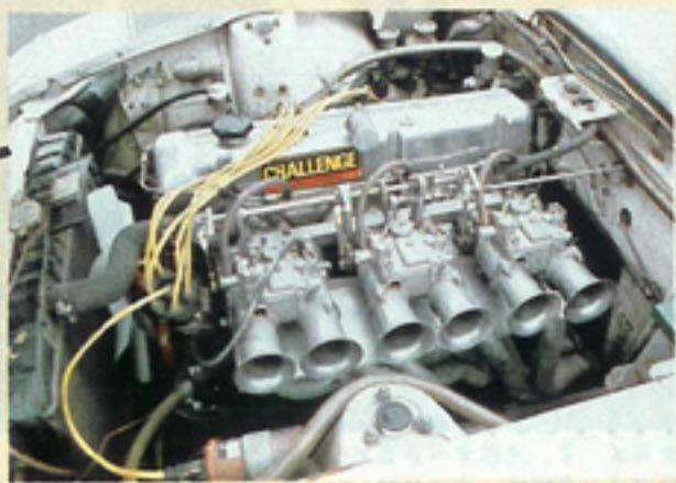
レーサーそのものの迫力を誇示するようになり出したワークスオーバーフェンダー、フロントスポイラー。今回のマシンの中では最も目立つマシンだった。エンジンはL28ベースの3.2L。ピストンは89・5mm、クラシック・コンロッドはイン44mm、エグゾースト36mm、ハイメム72、キャブレターはソレックス44φ、ミッションはクロス、デフはファイナル3でノンスリップ、オイルクーラー付。ホイールはスピードスター、F10J・R12J、タイヤはダンロップのスリックでF200/550、R1275、チューナーはチャレンジオリジナル。バルブレーブはオーナーの陸野サン。
