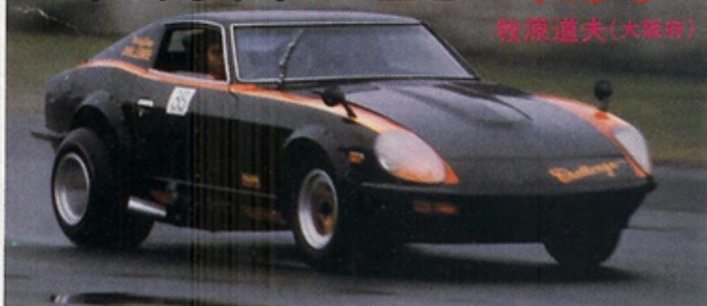
大阪府八尾市のチャレンジの店長さんが、自分で作りあげたマシン。3097ccの排気量にスペシャルパーツを組みこんだチューンだけにタイムが期待されたが、ソレックス50φのセッティングとサイドマフラーにトラブルが発生して不本意なタイムに終わった。ルーフは1度切断して、約9cmも下げているというチョッピングZで、カラーリングも決まっていたのでドレスアップ賞に輝いた。
