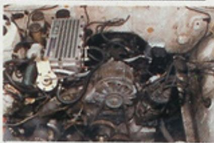
軽量小型のロータリーにKKKのターボを付け、サニーのデフと溶接してる
