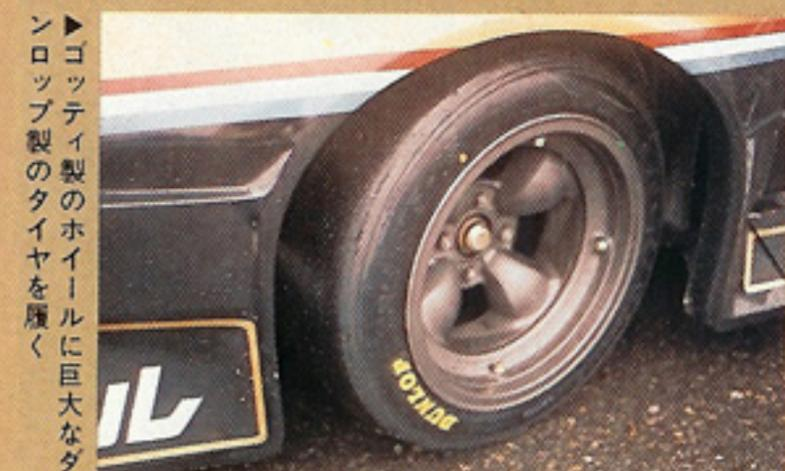
▶ゴッティ製のホイールに巨大なダンロップ製のタイヤを履く
