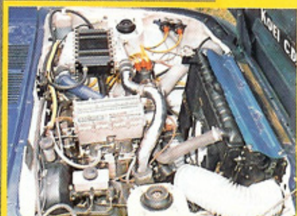
水冷式インタークーラーとエアリサーチャーターボをコンビした13B型RE。CDIも装着。
