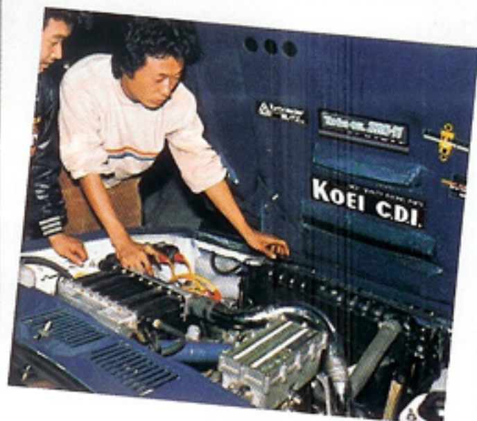
REとターボのマッチングは難しい。現状ではサイドポート式をトライしているが、将来的にはベリ方式にも進みたい。
