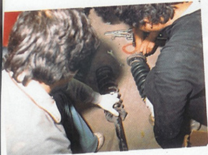
こちらも深夜のサスペンション交換作業。カヤバのモータースポーツ用ダンパーをセット。
