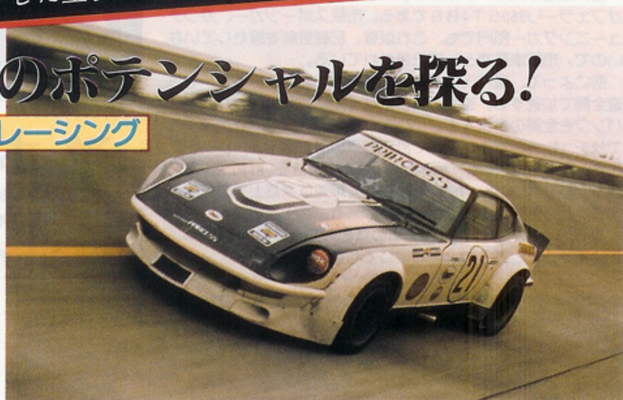
R390型クロスフローヘッドを装着したレーシング仕様。パワーは300PSを発揮。
