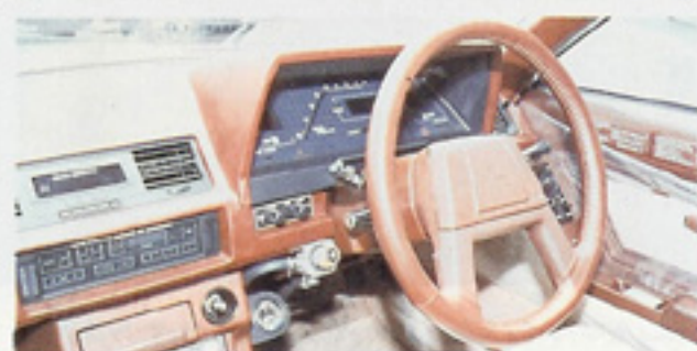
インパネ左下にブースト圧計とそれをコントロールする調整ツマミがつく。
