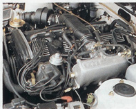
セリカ2800GTの5M-GEU型DOHC2.8L。市販車では最強の170馬力/5600回転。
