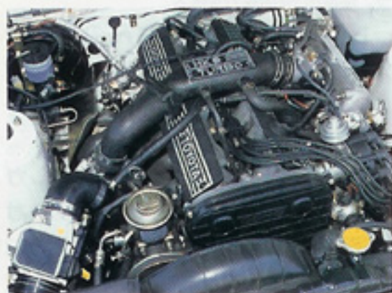
HKSのバースト・ターボをボルトオン。エンジンはノーマルのニッパチで過給圧0.46。
