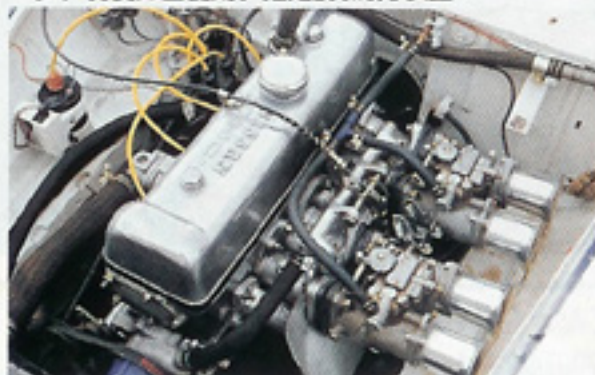
高性能の50年代を代表するSRのU20型。2160cc。ソレックス50φでフルチューンされている。
