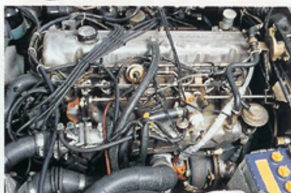
Dai Z。L28E型+HKSバイパス・ターボでチューン。68度カム使用。推定200馬力以上!
