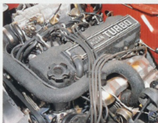
ガゼール・ターボはバルと同じZ18E・T型。最高出力135馬力/6000回転を発生。
