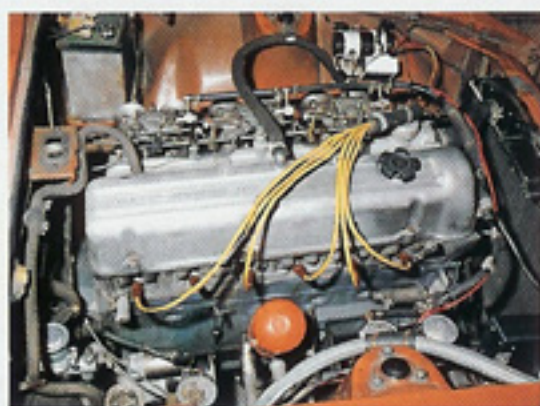
日産L型でトップ・クラスの久保チューン3QZ。270~280馬力のカリカリ・マシンだ。
