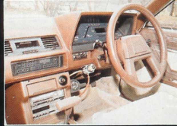
←メーターパネルの下にブースト圧を調整するツマミをもつソアラターボ。
