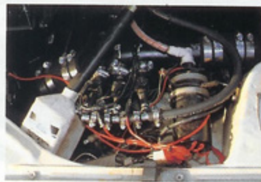
インタークーラーからの吸気パイプに3本のインジェクターを装備。ブースト0.8kg/cm 2 で作動。
