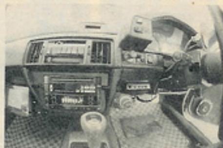
←FコンやEGC、そしてVVCと、ターボチューンの霧散気漏点。ブースト圧は0.65kg/cm 2 。
