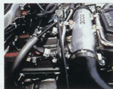
追加インジェクターにより、高速域でのターボのタレを解決
