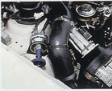
トラス製のVVCとAICをボンネット内に装着する
