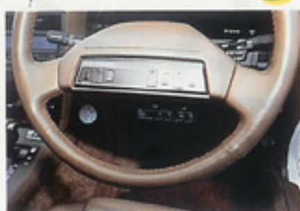
ブリッツ製のブースト計を装着。フルブーストでは0.65kg/cm 2 まで跳ね上がる
