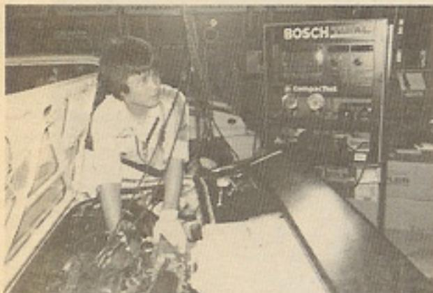
このエンジンをエンジンアナライザーでチェックしてみると、インジェクターの開弁時間にはほんの微妙なバラツキがあった。しかし、コンピューター、インジェクターノズルをチェックするほどの大きなものではないのでそのままにしておく。そして、点火タイミングのズレが3°ぐらいあり、これは正常にもどした。その他に関しては別に異常なし。
