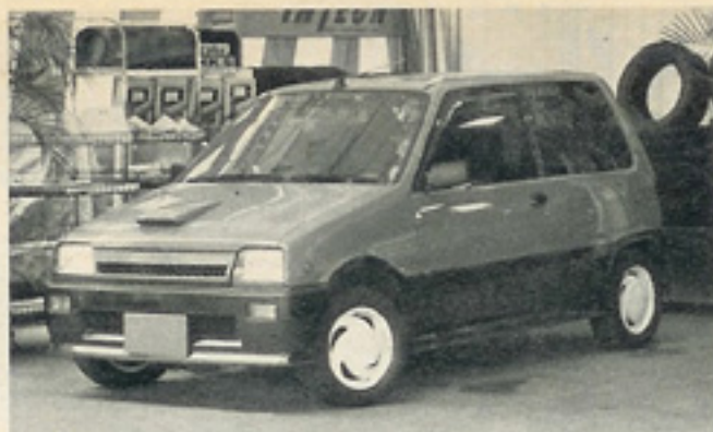
現在セッティング中のトライアル・ミラ・ターボ。ブースト1.1 kg/cmで67psをマークしている。
