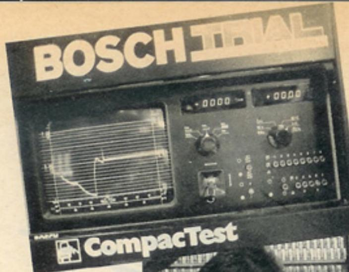
これがボッシュのエンジンアナライザー。エンジン各部のデータをすべてオシロスコープで表示できる。
