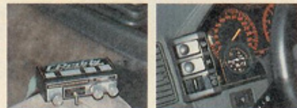
↑トラストのレピックでサブインジェクターの燃料を調整し、ブーストメーターはブリッペンジェクターの燃料を調整し、ナセル内にベストなエンジン状態にする。ナセル内にキレイにセットされていた。
