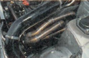
↑ステンのマニホールドはかなり前方に延びるが等長タイプとなっている。
