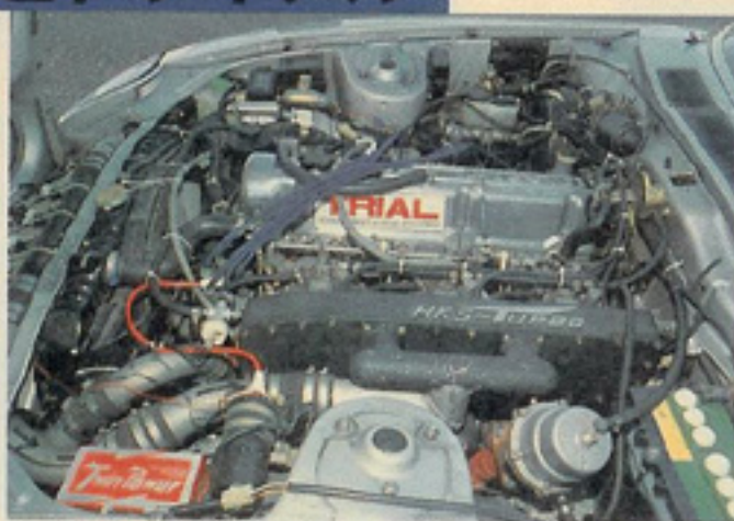
↑エンジンは東名の89mm鍛造ピストンを組み込んで圧縮比を下げ、カムはHKSのコンカムを組むキャプターボ仕様
