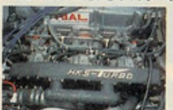
↑OER50のキャブにはHKSのサージタンクが付く。ハイブーストに耐える製品でなくてはならない
