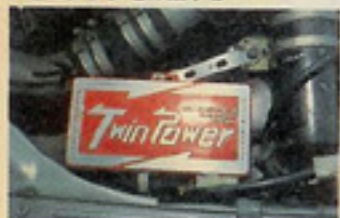
↑ツインパワーはHKSのもの。CD Iひとつのトラブルもゆるぎないのて確実なものが必要だ
