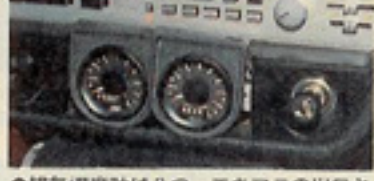
↑排気温度計は2つ。エキマニの出口と、集合部の2つの位置にセンサーが付けられている
