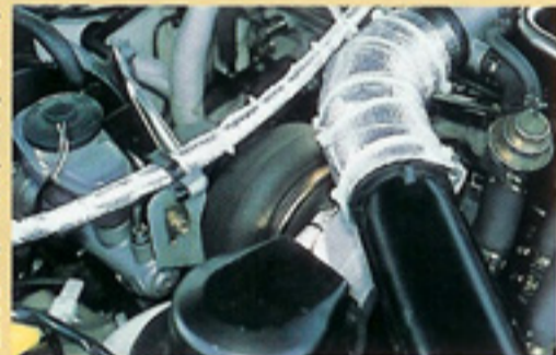
TD-07タービンは25Aの12cmで、HKSのニューウエストゲートで挟んでいる
