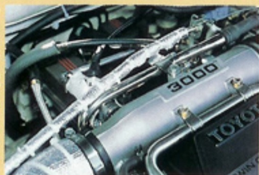
700ccのサブインジェクターが2本追加され、AICで調整される
