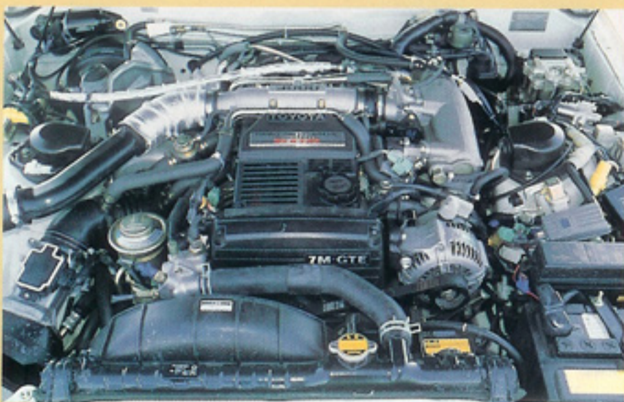
エンジンにはノーマルでタービンがTD-07に交換された他、HKSのニューレーシングウエストゲートが付く
